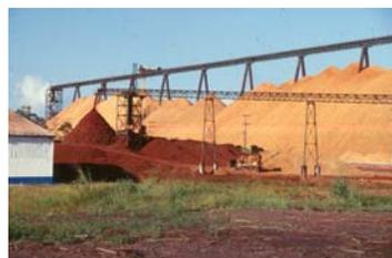
*Astillas de madera procesadas para la fabricación de pulpa química como materia prima para la producción de papel*
