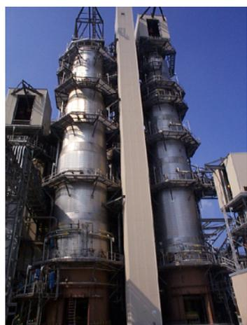
*Digestores continuos utilizados para la cocción de astillas de madera en una fábrica de producción de pulpa*
