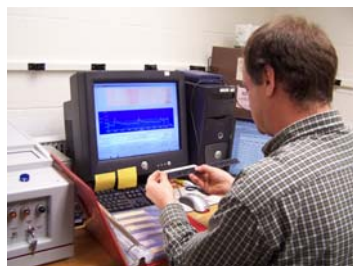
Figura 1. Willi Woodbridge, investigador de Camcore, tomando mediciones del perfil de densidad de la madera con la técnica de densitometría de rayos X.
