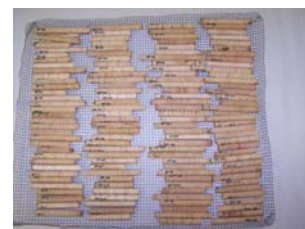
Figura 3. Secado de muestras de madera de diferentes especies de pino recibidas de la empresa Bosques del Plata en Argentina.
